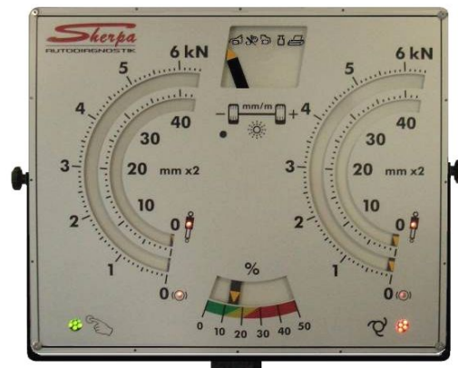
Afișaj analog cu ace cu etrier rabatabil
